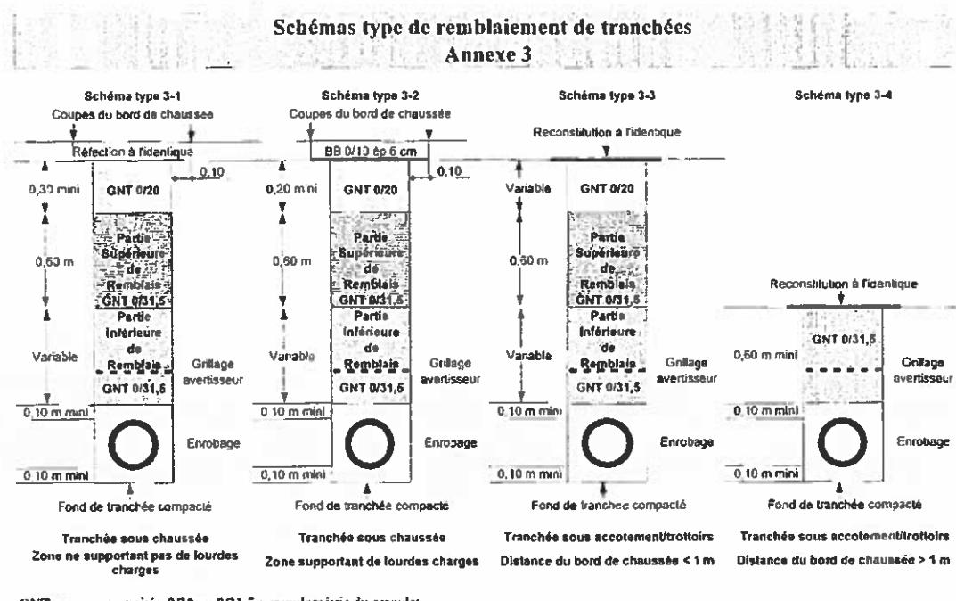
– Schéma 3-2 : Schéma de remblaiement de tranchées pour zones supportant des charges lourdes
